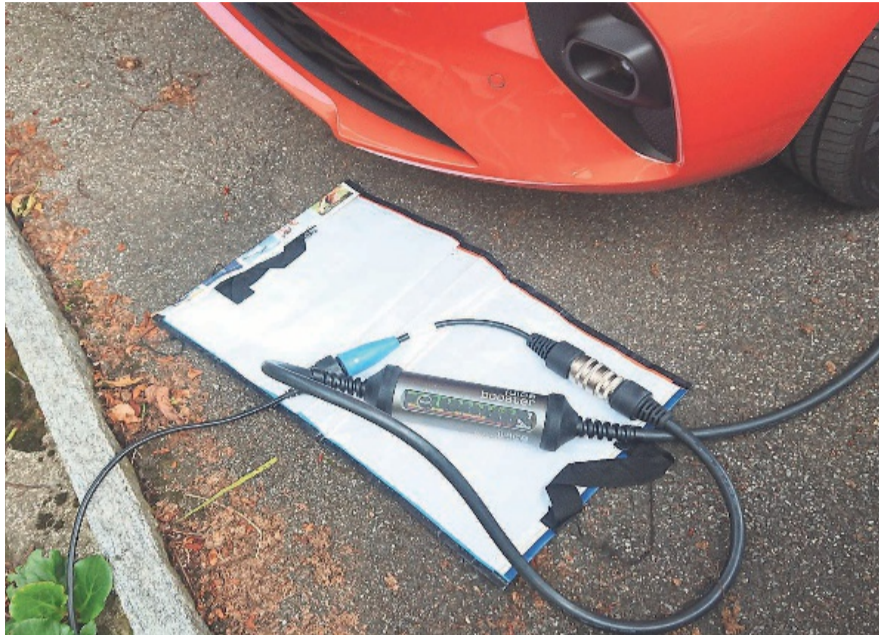
Hochwertige Ladegeräte für die Steckdose wie der JuiceBooster haben eine Leistungssteuerung, Adapter für mehrere Länder und Temperaturüberwachung. BILD ZVG
